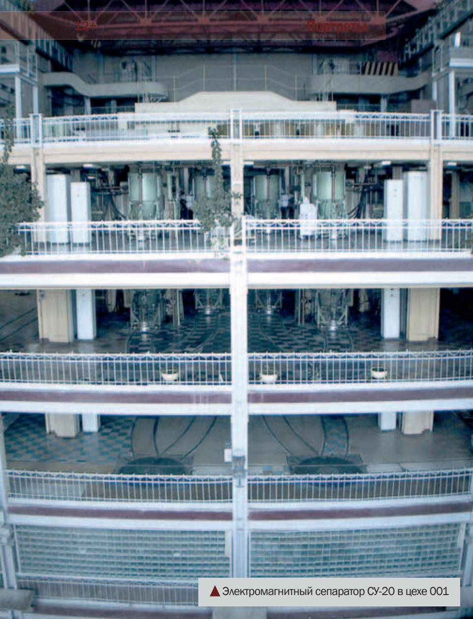
▲ Электромагнитный сепаратор СУ-20 в цехе 001
